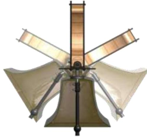
*Le centre de gravité de l'ensemble cloche + mouton est situé près de l'axe de rotation et ne provoque que peu d'efforts latéraux. La cloche est équilibré par son propre poids et le mouton. Le battant frappe en bas. La sonnerie est lente et un peu triste. Une des variantes est le retro-lancé.*
