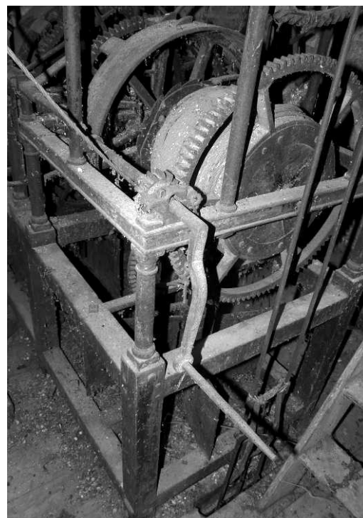
Barillet et volant-aérofrein d'un des deux systèmes de sonnerie
