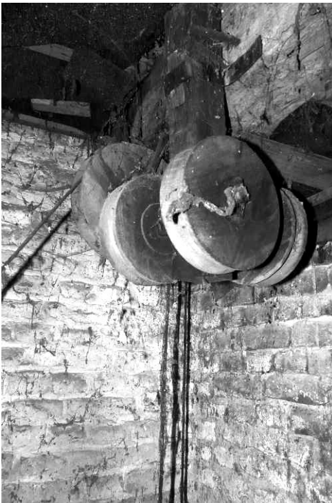
Système de poulies pour la remontée des poids
