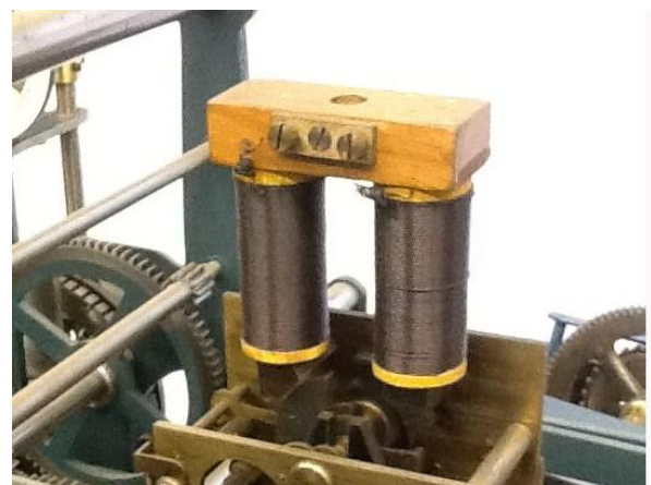
Système électro-magnétique dans une horloge de la Hörz Turmuhrenfabrik
