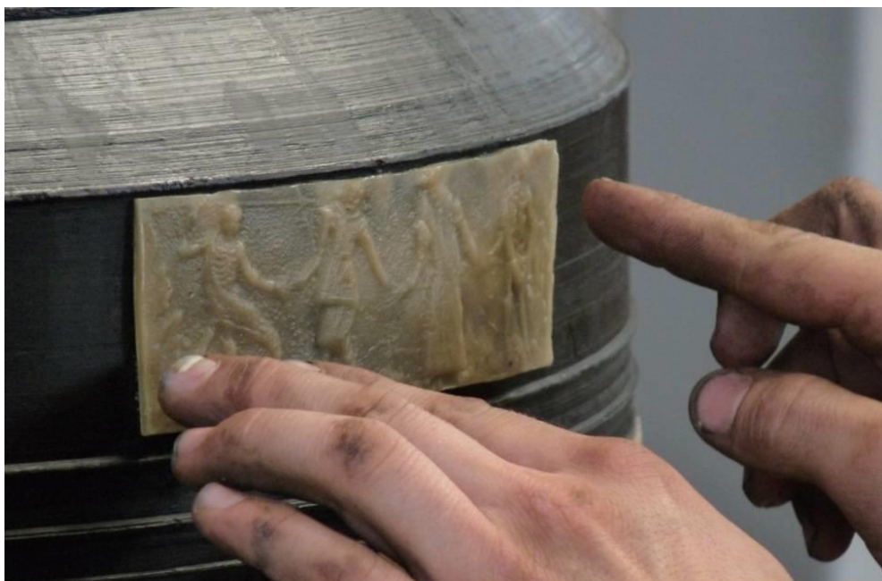
Fig. 10 : l'artiste ajustant sur le noyau de la cloche l'empreinte de danse macabre réalisée en cire
