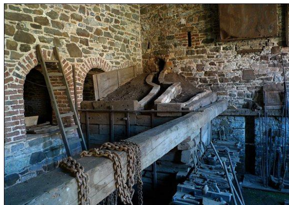
Chenal servant à guider le métal en fusion du four vers la fosse de coulée
