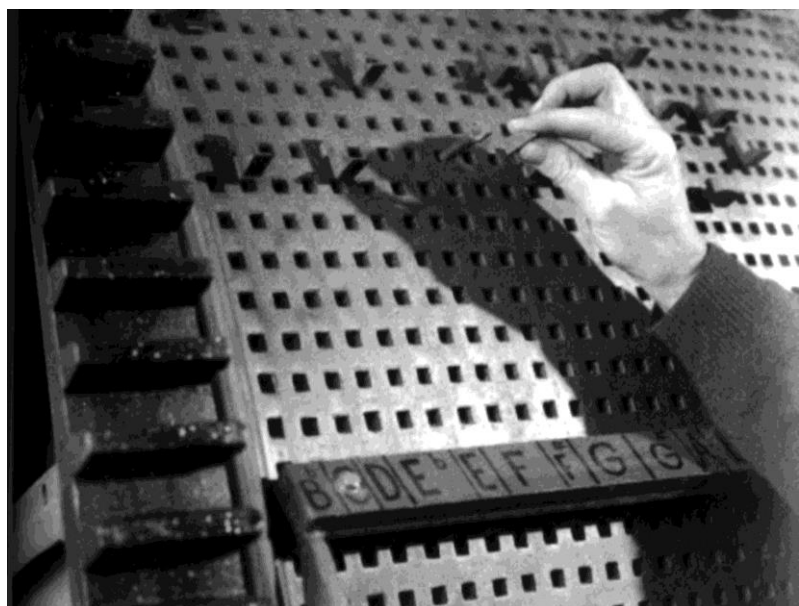
Programmation d'un tambour de carillon automatique
