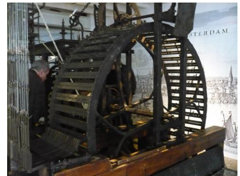
Tambour programmable pour carillon automatique
