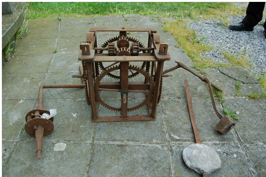
Manivelle, balancier et mécanisme de transmission de l'heure vers les cadrans
