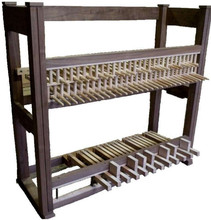
Fig. 1 : La structure du meuble avant réalisation de la mécanique
