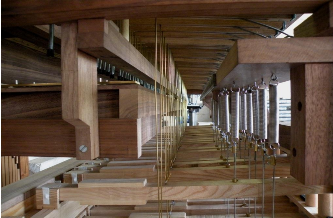
Fig. 3 : Vue de la mécanique en haut : les bascules avec leurs tiges filetées (à g.) et leurs ressorts (à dr) à droite : les ressorts de rappel des pédales en bas : les touches du clavier à gauche : le châssis portant les plaquettes de métal
