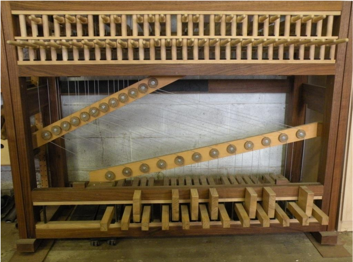
Fig. 5 : Le mécanisme de raccord du pédalier au clavier manuel
