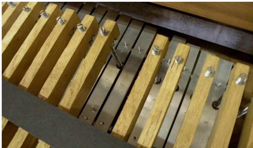
Fig. 4 : Les bascules On notera sous l'extrémité de chacune d'elles l'insertion d'un écrou auto-serrant empêchant un jeu trop souple des tiges filetées
