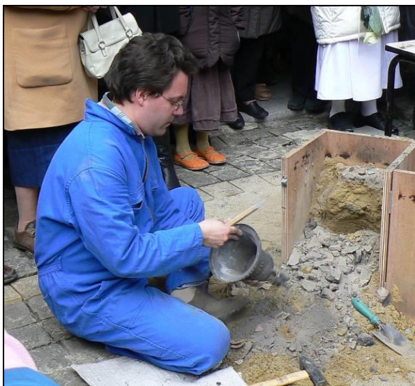
Le démoulage de la cloche
