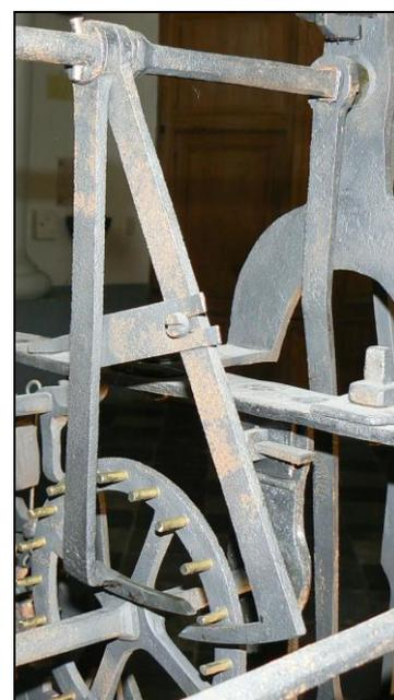
*Roue d'échappement et ancre (à l'avant-plan)*
