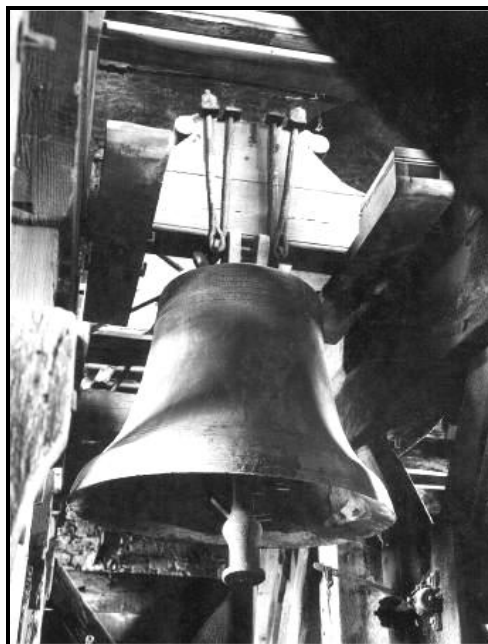
Ancien système par bascule pour la mise en branle des bourdons de la cathédrale St-Michel (Bruxelles)
