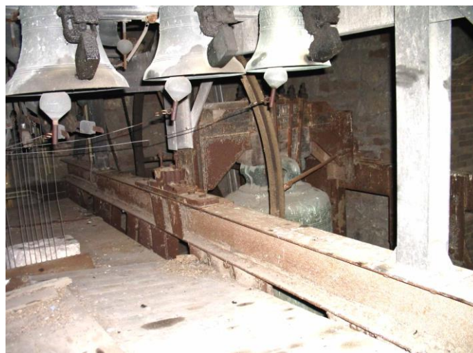
Battants à boule rapportée. A l'arrière-plan, on distingue les équerres munies de contre-poids. Sur la gauche, la cloche de 1.211 kg.
