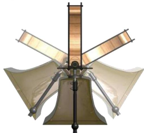
*Le centre de gravité de l'ensemble cloche + mouton est proche de l'axe de rotation. Le battant frappe en bas. En termes de métier on dit : « la cloche rattrape le battant ». Une des variantes est le rétro-lancé.*
