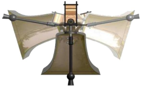
*Une cloche est en lancé-franc lorsque les axes ou les tourillons sont au même niveau que la partie supérieure des anses. Le centre de gravité de la partie en mouvement est donc plus bas que l'axe. Le battant vient frapper le bord supérieur de la cloche lorsque celle-ci est à son amplitude maximum. La propagation du son est meilleure puisque le rayon de volée est maximum. C'est le mode de sonnerie le plus puissant. En termes de métier on dit : « le battant rattrape la cloche ».*
