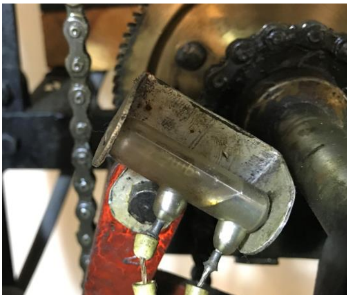
Interrupteur à mercure servant de butée en fin ou début de course pour l'arrêt ou le démarrage de la remontée des poids.
