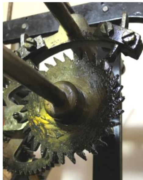
L'échappement est de type à « ancre de Graham perfectionné par F. Leonhard ».
