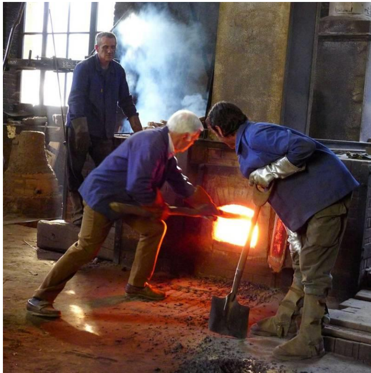
Dominique Bollée, maître-fondeur de cloches à Orléans, brasse le métal au moyen d'une perche en bois vert.
