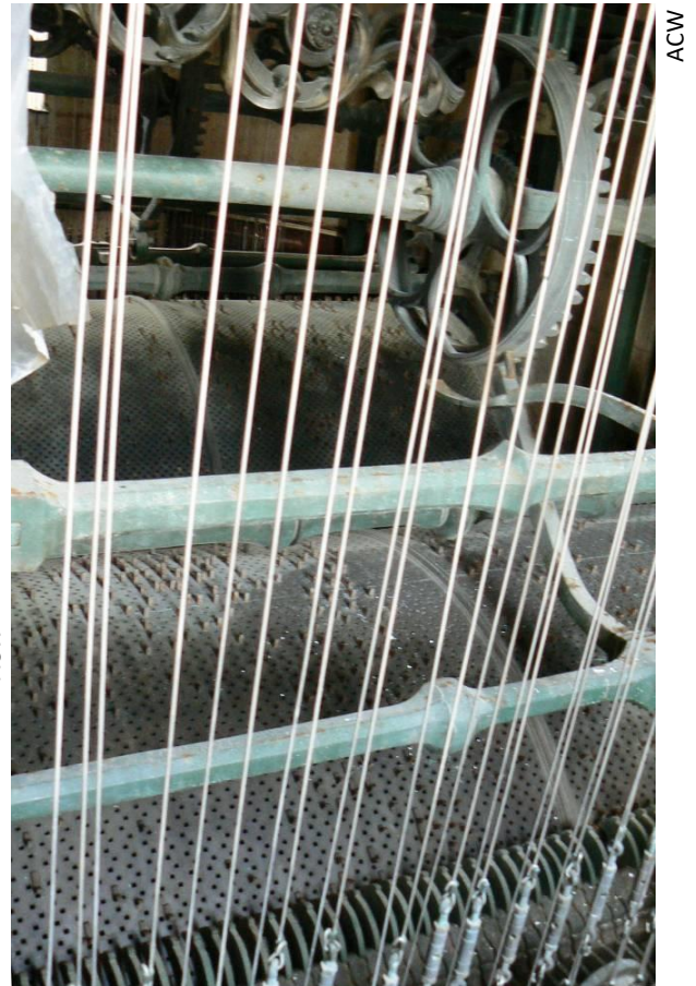
Tour sud : liaison entre un des tambours de programmation et les cloches du carillon
