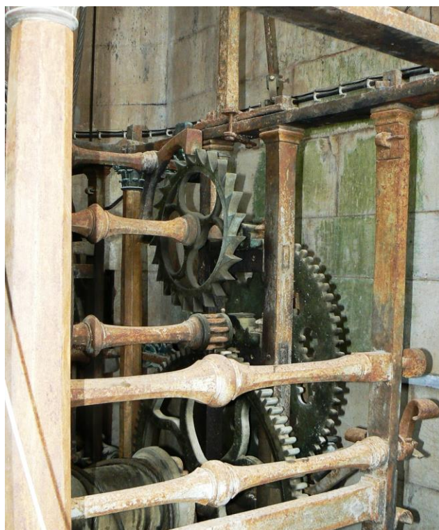
Horloge de la tour nord : échappement à ancre et axes stylisés
