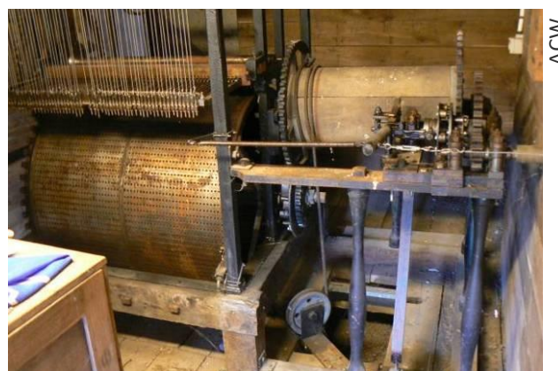
Mécanisme du carillon automatique
