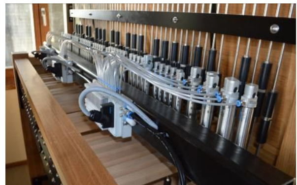
Système pneumatique assurant les ritournelles automatiques par enfoncement des touches à l'arrière du clavier
