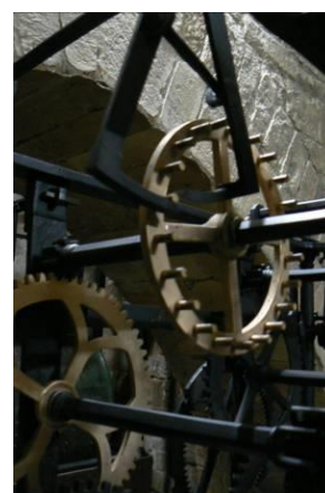
Mécanisme d'échappement de l'horloge restaurée
