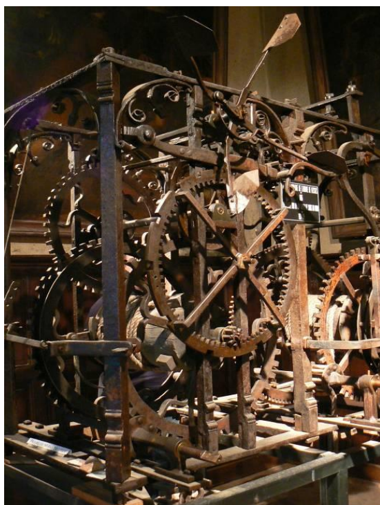
Détails du mécanisme de sonnerie
