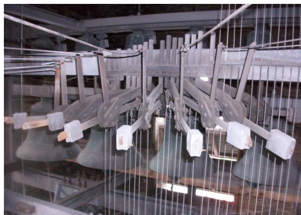
Liaisons entre le clavier et les cloches
