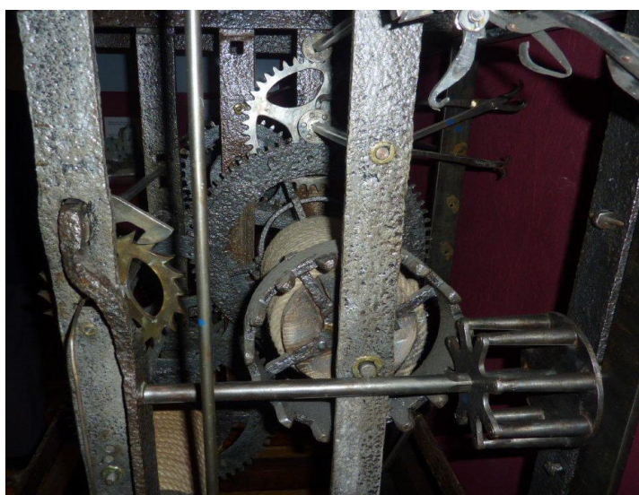
Détails de l'horloge (dont l'échappement à ancre à gauche de la photo)
