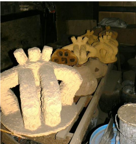
Atelier de préparation de moules de couronnes de cloches
