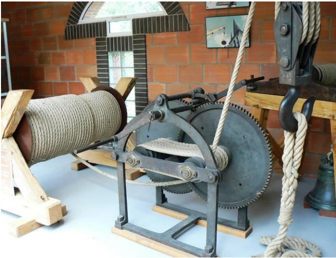
Dispositif pour la montée et la descente de cloches dans les clochers
