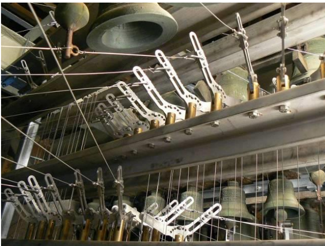
Système de liaison à équerres réglables
