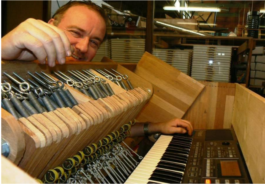
Accès au clavier du synthétiseur par basculement du système de transmission
