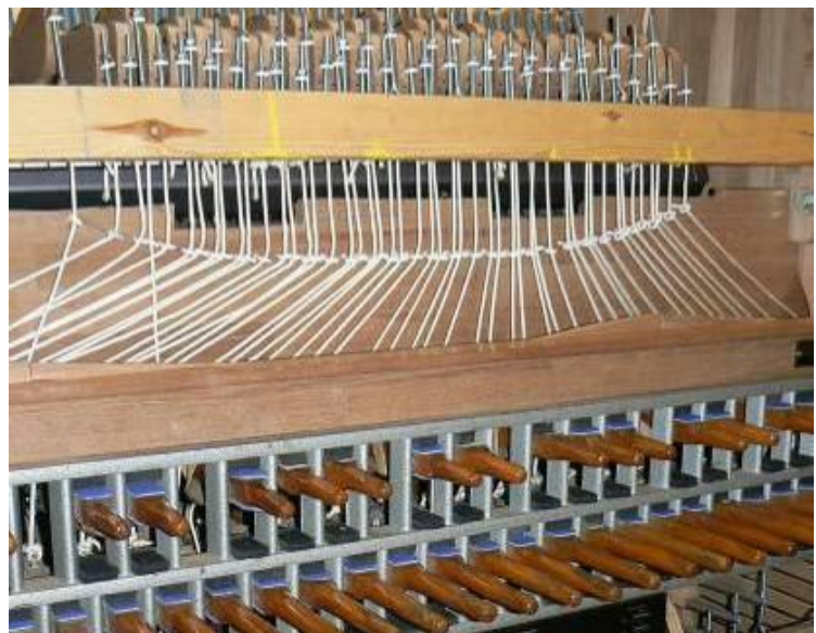
Vue frontale du système de transmission entre le clavier de carillon et celui du synthétiseur
