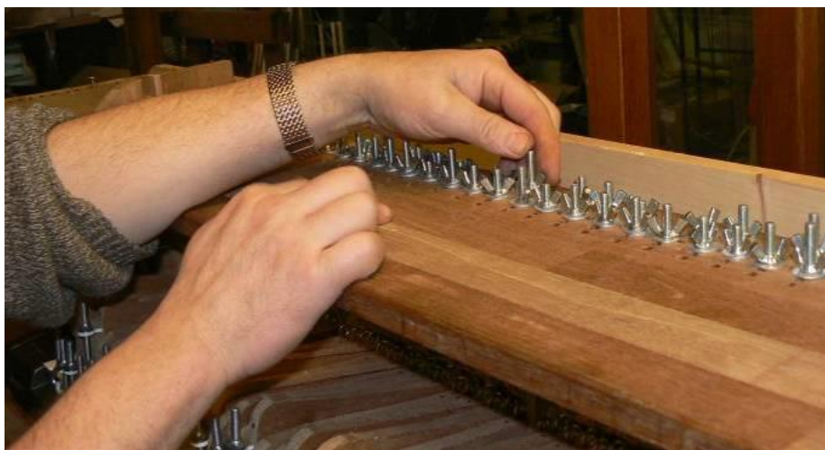
Réglage des ressorts de rappel des marteaux en bois
