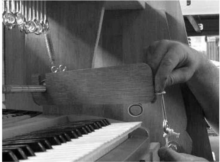
Marteau en bois en cours d'installation (l'anneau en caoutchouc fixé à la face inférieure du marteau effectue l'enfoncement de la touche du synthétiseur)
