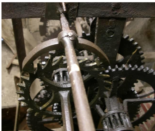
L'échappement à ancre
