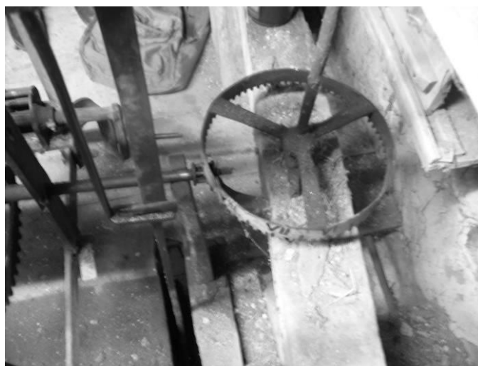
Départ du mécanisme de renvoi des heures vers le cadran
