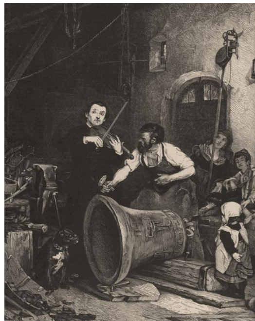
Caractérisation à l'ouïe de tons partiels de cloches dans le passé
