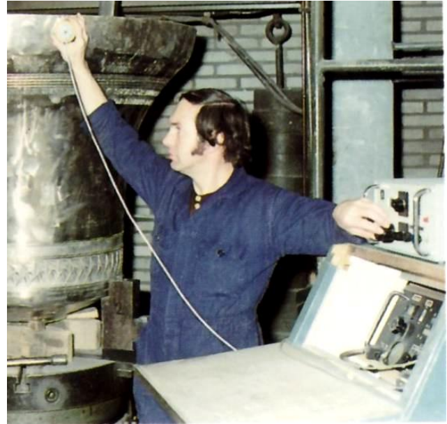
Mesure de tons partiels d'une cloche par un générateur de fréquences
