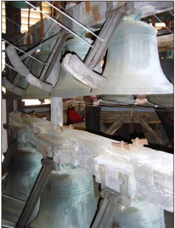
*Les marteaux actionnés par la machinerie du carillon automatique (photo Ph. Slégers)*
