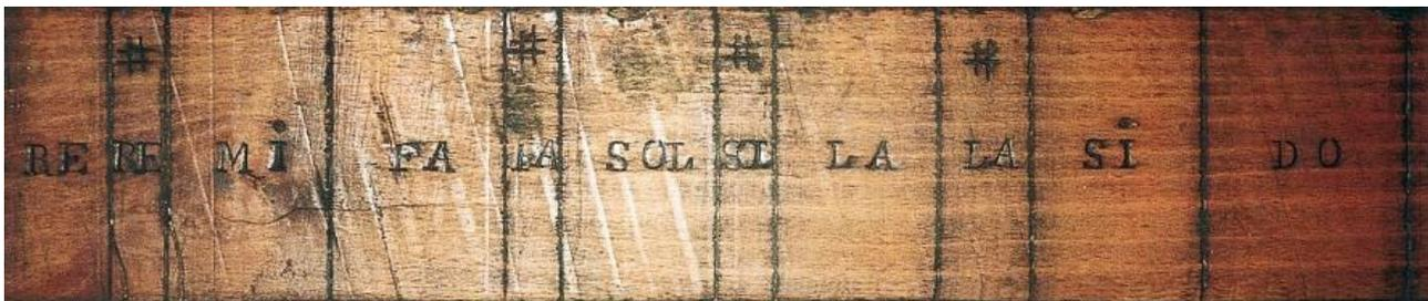
*Réglette servant au repérage pour le positionnement des chevilles en fonction de la mélodie à réaliser (Photo R. Jacob)*
