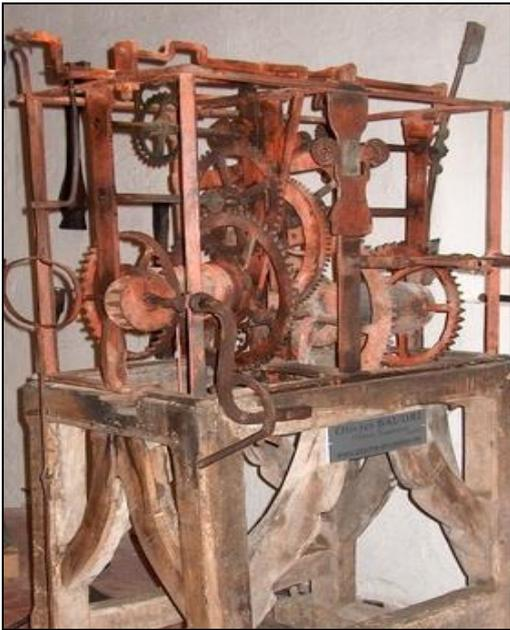
Cette pièce comporte plusieurs originalités, dont une roue dentée actionnée par la manivelle (mais dont les dents sont perpendiculaires à la roue), un levier de contrôle de la roue de compte intégrée à l'écusson du fabricant, un échappement et un balancier en deux parties (qui pouvait renforcer le recul) et, enfin, un balancier comportant, au centre de la tige portant le poids, un cercle qui permettait le passage de l'axe commandant les aiguilles du cadran.
