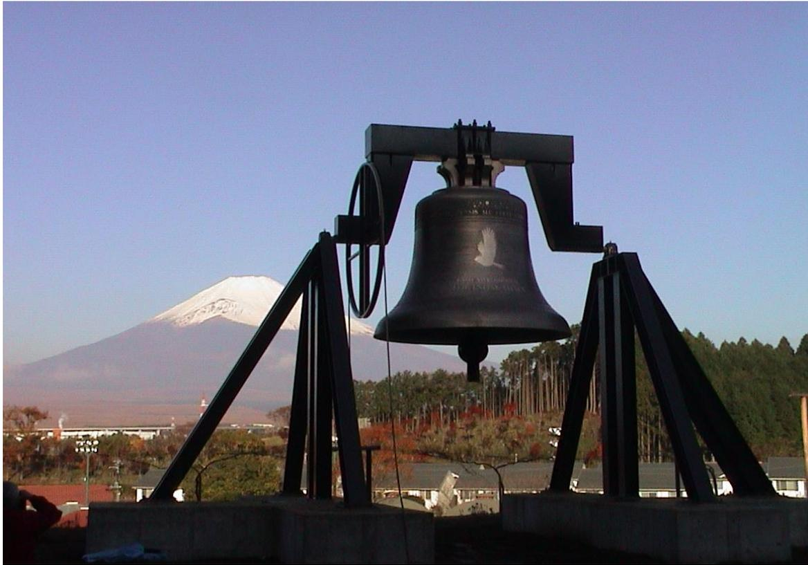
La fonderie ROYAL EIJSBOUTS a fondu fin 2006 la plus grosse cloche de volée du monde. D'un poids de 36.250 kg et d'un diamètre de 3.82 mètres, la cloche a été installée à Gotenba City (Japon), à proximité du Mont Fuji.
